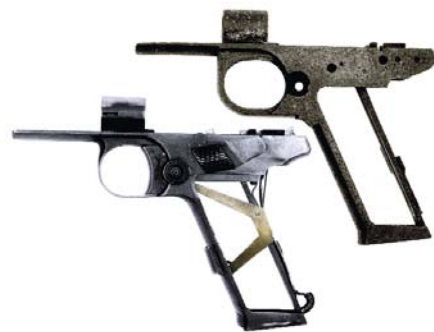
Заготовка и полностью обработан- ная рамка пистолета обр. 1930 г.
